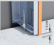
Teleskoprohre in der Gegenseite einhängen. Mit Steckbolzen sichern und mit Gewindespindel ausrichten.
