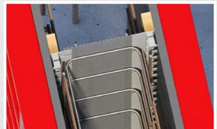
Schliesst diese Zwischenräume bei Bodenplatten und Decken in der unteren Armierung und bei Wänden auf beiden Seiten der Armierung
