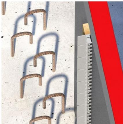
Bei Wänden kann der Abschalkamm stirnseitig auf ein Drängbrett aufgenagelt und die Armierungseisen und das Abschalelement AES/AEF befestigt werden
