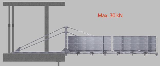
Zum Anheben der MS-Plattform Extrem XL 3000 sind die 4-Strang-Gehänge an den, speziell für das Anhängen vorgesehene und gelb markierten Aufhängepunkte, anzuschlagen.
