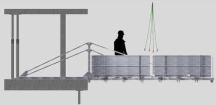
Werden Deckentische aus- und eingefahren, sind die Deckenstützen an der Deckenunterschicht ebenfalls mit einem DW-Anker Ø15 mm zu sichern.
