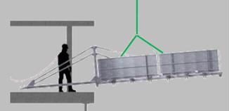
MS-Plattform Extrem XL 3000 muss ganz an der Betonkante angelegt werden, so dass der Kräfteverlauf, gemäss der berechneten Statik, nicht beeinträchtigt wird. Die Tragholme müssen im rechten Winkel zu der Betonkante montiert werden. Im Winter ist darauf zu achten, dass die Bereiche der Auflage der Tragholme von Schnee und Eis absolut frei sind.
