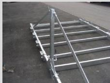
Einstecken der Seitenschutzgeländer und des Frontschutzes.
