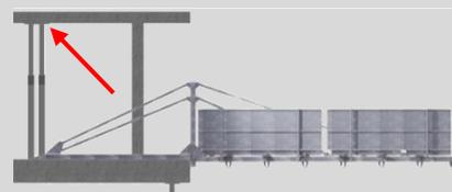
Die nötige Untersperrung vornehmen und die entsprechenden Sicherheitsmassnahmen gegen das unkontrollierte Wegrutschen treffen (Rücksprache mit dem örtlichen Bauingenieur).
