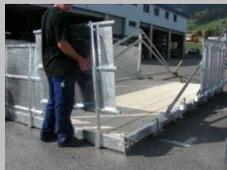
Die Seitenschutzgeländer mit Aussparungen sind beim Frontschutz einzustecken. Die Aussparungen sind dabei bei den Befestigungspunkten für die Zugbänder platziert.
