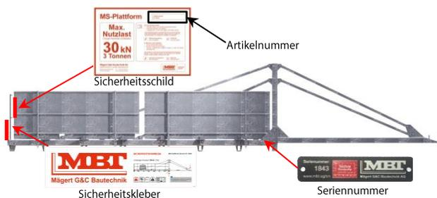
Ist auf dem Sicherheitsschild hinter dem Artikelnummer „Spez.“ angefügt (Bsp.: Art.Nr. 4356 Spez.), wurde dieser Aufbau- und Verwendungsanleitung ein Beilageblatt beigelegt. Auf dem Beilageblatt sind die Abweichungen gegenüber dieser Aufbau- und Verwendungsanleitung angegeben. Wenn ihr Beilageblatt nicht mehr in ihrem Besitz ist, fordern Sie dies bei Mägert G&C Bautechnik AG an und geben Sie die Seriennummer an.
