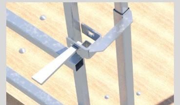
Die Keile durch die Aussparungen hindurchführen und mit Hammer festziehen.
