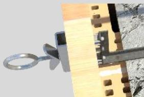
Randfix-Winkel auf Deckenschalung ausrichten und je Randfix-Winkel drei Löcher Ø6x40 in Elementdecke bohren.
