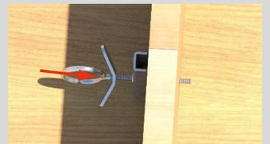
Der Gewindeschutz welcher am Distanzstern des Randfix-Winkels befestigt ist, wird über das Gewinde gestülpt.
