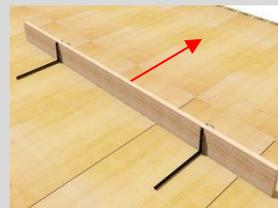
Die Randfix-Winkel auf der Deckenschalung ausrichten und mit je drei Alu-Nägeln Ø3.1 x45 mm aufnageln.
