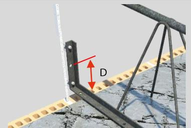
Das Bohrloch Ø12 mm ist in das Schalbrett zu bohren mit dem Abstand von Mass E und den gegenseitigen Winkelabständen gemäss Tabelle unter Punkt «Technische Daten».
